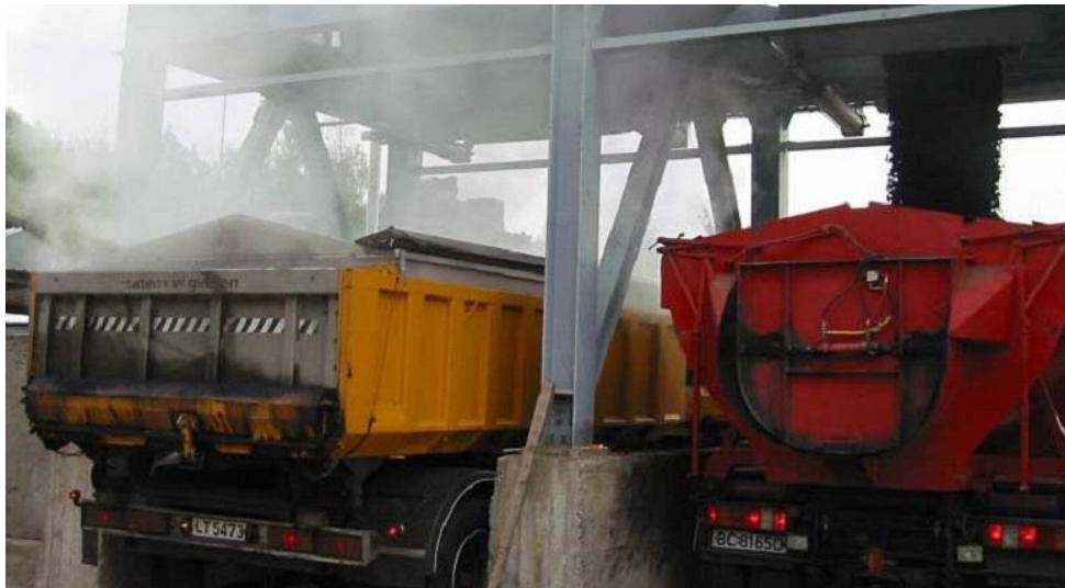
Camiones cargados con una mezcla a 180 °C y a la izquierda a 115 °C
